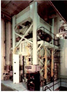
图3 NRC的火灾炉及力学边界条件
